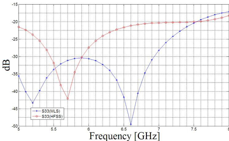
Figure 9. Scattering parameter  $S_{33}$  of example 2.
