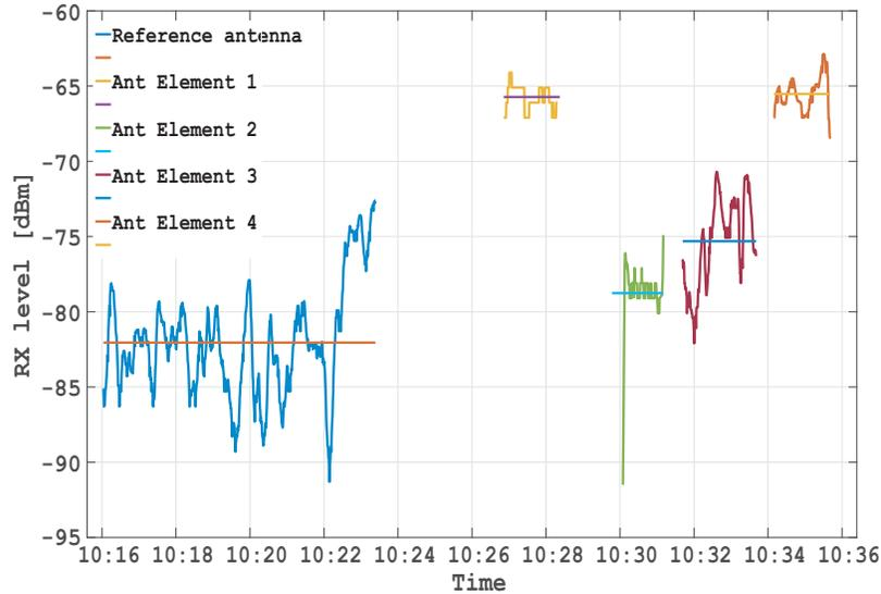
**Figure 5.** Measured RX level in Talvivaara Kajaani.
