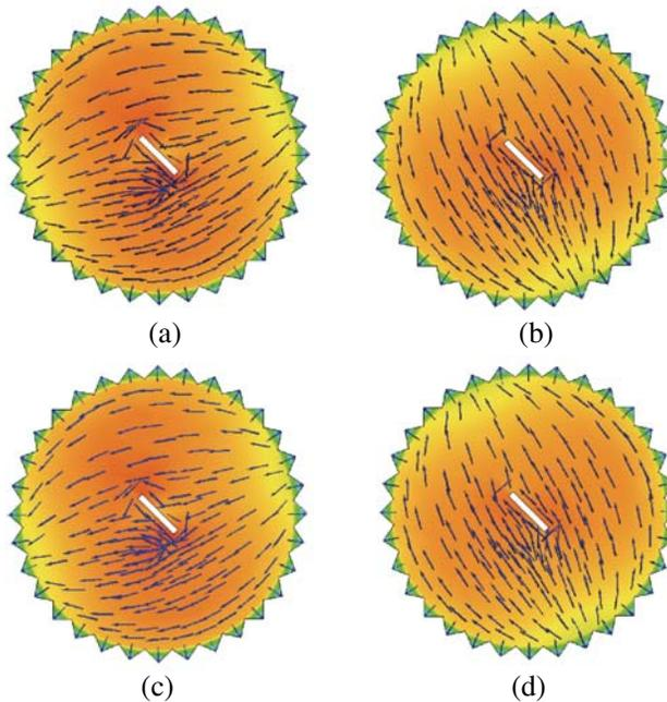
Figure 6. Surface current at 2.45 GHz. (a) 0°, (b) 90°, (c) 180° and (d) 270°.
