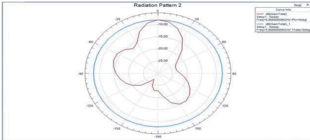
**Figure 7.**  $E$ -plane and  $H$ -plane radiation pattern.
