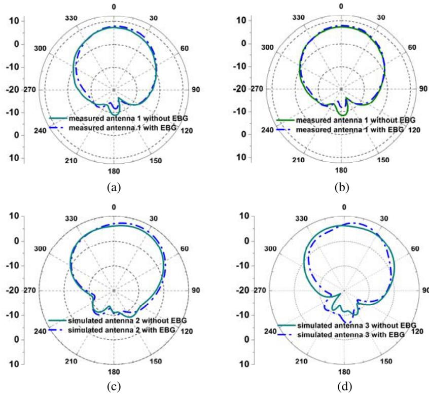
**Figure 6.** Radiation patterns of antenna units. (a) Antenna 1 (8.6 GHz),  $xoz$ -plane. (b) Antenna 1 (8.6 GHz),  $yo z$ -plane. (c) Antenna 2 (12.5 GHz),  $xoz$ -plane. (d) Antenna 3 (16.5 GHz),  $yo z$ -plane.
